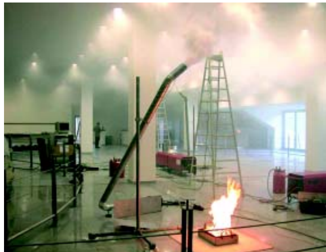
Deckennahe Rauchsicht in einem Multifunktionsraum
