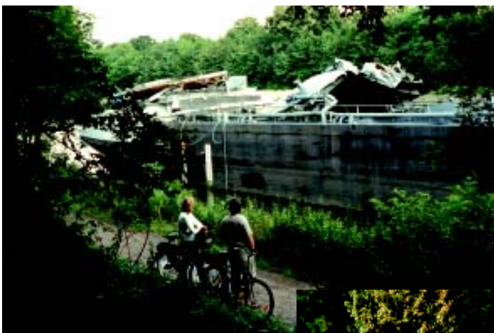
Tankschiff nach Explosion beim Entgasen der Tanks
